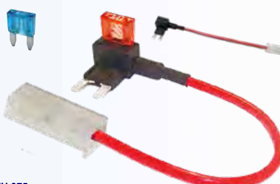
FU.975 Circuit zekeringhouder voor 2 mini steekzekeringen 2-30A 1.3mm 2 (AWG 16) rode kabel, lengte 100mm, met aansluit blok 6.3 mm. (10)
