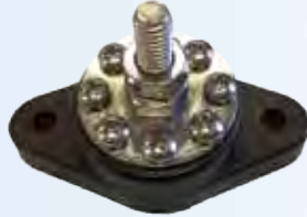
AP.075 1 8 polig 160 Amp - 12V 8-weg aansluiting. Kleur zwart M8 bout in het midden + 8 M4 schroeven voor andere aansluitingen. Dim: H53.8xW45.4xD85.0
