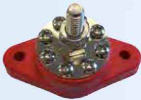
AP.074 1 8 polig 160 Amp - 12V 8-weg aansluiting. Kleur rood M8 bout in het midden + 8 M4 schroeven voor andere aansluitingen. Dim: H53.8xW45.4xD85.0
