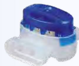
KV.1592 Aantal polen 3 Breedte (mm) 25 mm Hoogte (mm) 17 mm Diepte (mm) 23 mm Kabeldiameter tot [mm] 3,8 mm Doorsnede (mm 2 ) vanaf 0,5 mm 2 Doorsnede (mm 2 ) tot 2,5 mm 2 25
